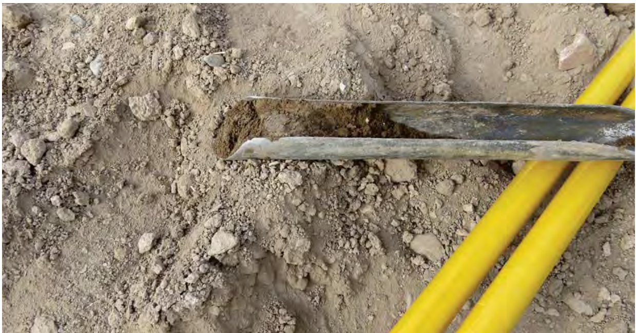
تصویر ۵. ابزارهای دریلینگ، میله های یک متری که به هم متصل می شوند و سرمته.
