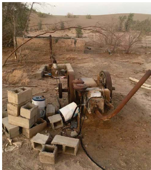
تصویر ۲. موتور آب بلااستفاده در عرصه محوطه و حوضچه ذخیره آب (برگرفته از مرتضوی ۱۳۹۸)
